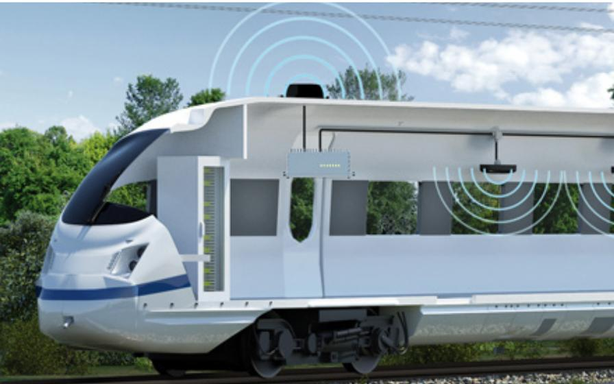
— Drahtlose Geräteverbindung in Bahnanwendungen. Mehrere Antennen pro Zugangspunkt sorgen für eine Drahtlosabdeckung im Zug
