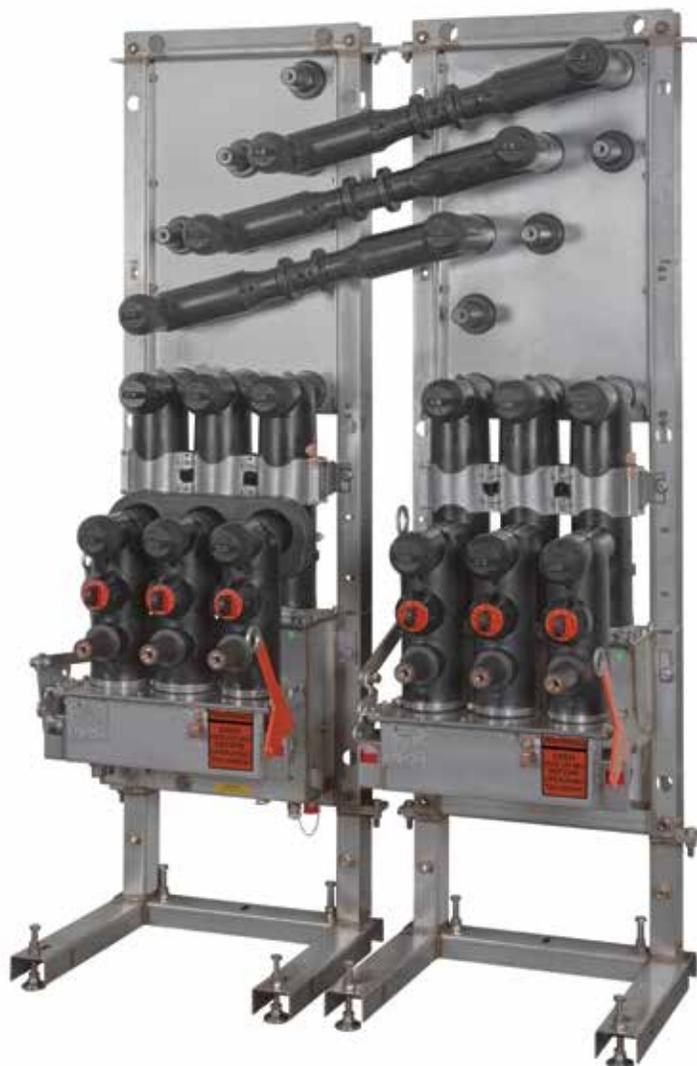
Conçu pour fournir un niveau de sécurité supplémentaire aux monteurs de ligne, le module d'appareillage de commutation Tru-Break est une unité modulaire actionnée par la perche isolante innovante qui se verrouille mécaniquement avec l'interrupteur connecté pour que la poignée du module d'appareillage de commutation Tru-Break ne puisse pas être actionnée si l'interrupteur est en position fermée et que la bouteille à vide conduit le courant.
