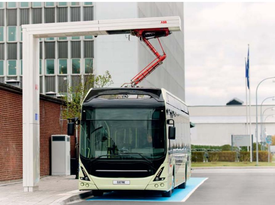
La solución de carga de oportunidad de ABB para autobuses eléctricos permite la recarga rápida en las cabeceras de la línea, con lo que se consigue un transporte público en las ciudades con cero emisiones. Gracias a su conexión automática en el techo y los tiempos típicos de carga de entre 3 y 6 minutos, el sistema puede integrarse fácilmente en las líneas existentes de autobuses, aprovechando los tiempos de regulación en las cabeceras para cargar el autobús.
