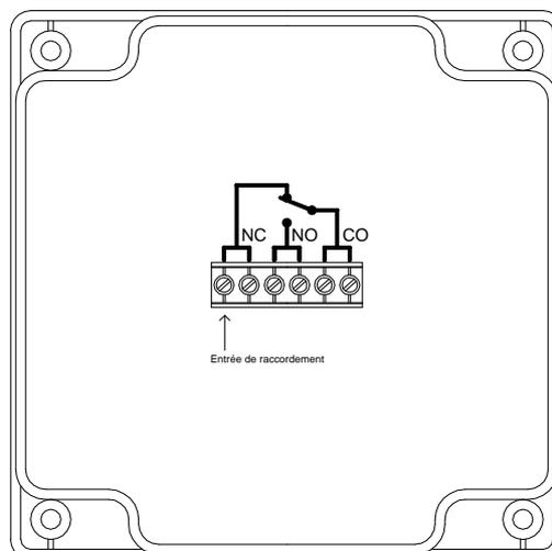
**Raccordement du Déclencheur Manuel DMMD ET ROUGE sur :**
