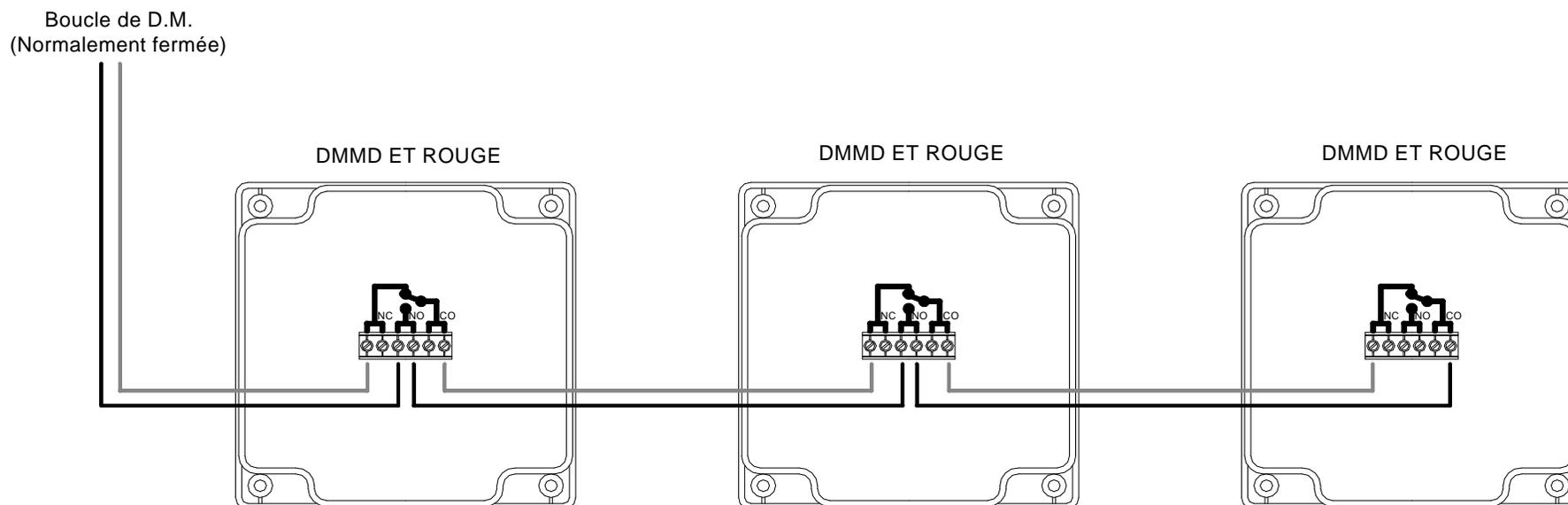
Raccordement en mode surveillé non disponible (absence de résistance d'alarme dans le DMMD ET ROUGE).
