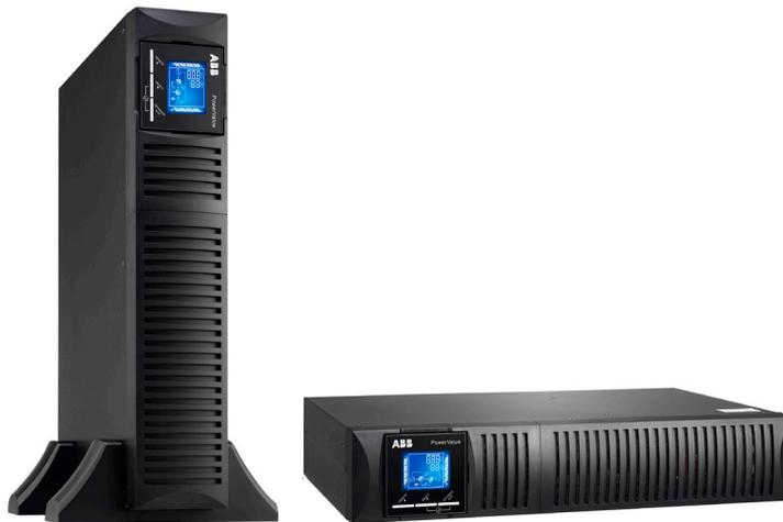
El PowerValue 11 RT de ABB es un SAI de doble conversión en línea que garantiza hasta 10 kVA de energía limpia y fiable para sus aplicaciones monofásicas críticas. Además de mantener la alimentación de sus servidores, terminales de punto de venta, grupos de estaciones de trabajo, enrutadores, conmutadores, concentradores y equipos electrónicos sensibles, el PowerValue 11 RT también regula la potencia de entrada para eliminar picos, altibajos, bajadas de tensión, ruido y armónicos.
