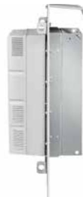
El montaje con brida reduce la carga térmica en el interior del armario separando la refrigeración de control y potencia.
