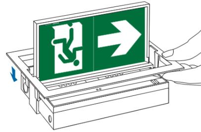
**J** Recourber les ressorts vers l'arrière et emboîter le produit dans le faux plafond. Le bloc est à présent correctement installé
