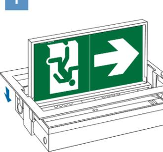
**J** Recourber les ressorts vers l'arrière et emboîter le produit dans le faux plafond. Le bloc est à présent correctement installé
