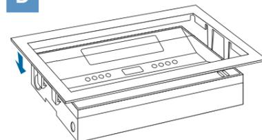
**E** Recourber les ressorts vers l'arrière et emboîter le produit dans le faux plafond. Le bloc est à présent correctement installé
