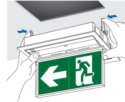
**K** Clipper la collerette de finition sur la platine en positionnant les trous des LEDs SATI en face de ces dernières
