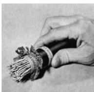
3. Posizionare la ferula esterna GSC sopra le schermature ripiegate centrandola sulla ferula interna. Le schermature vanno ordinate lungo il bordo della ferula esterna prima o durante la compressione. Il cavo di ripresa di massa viene inserito sotto la ferula esterna prima della compressione.
