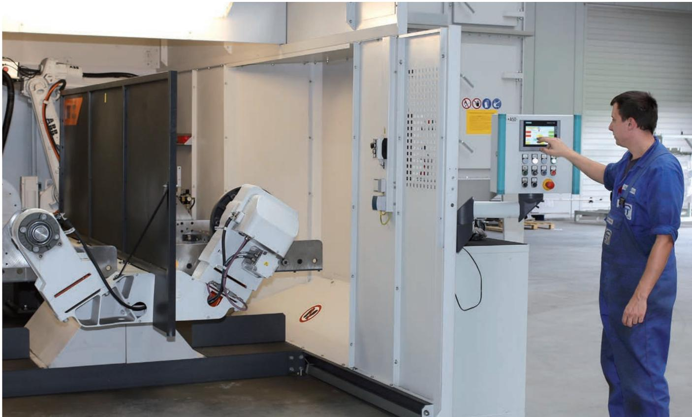
In der Standard-Schweißzelle FlexArc RX1 arbeiten ein Schweißroboter IRB 2600ID und ein Positionierer IRBP R-600.
