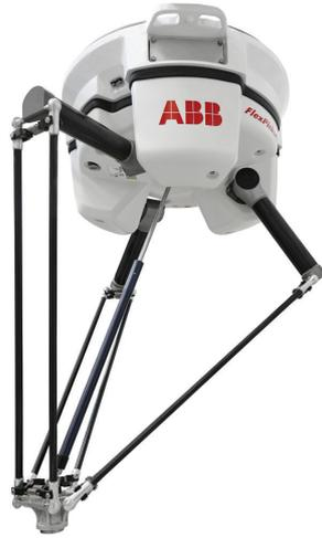
Una volta ordinati, sono trasportati sotto due file di robot ABB del tipo FlexPicker IRB 360 con sistemi di visione (un sistema per fila) per il riconoscimento della posizione e del tipo di prodotto.
