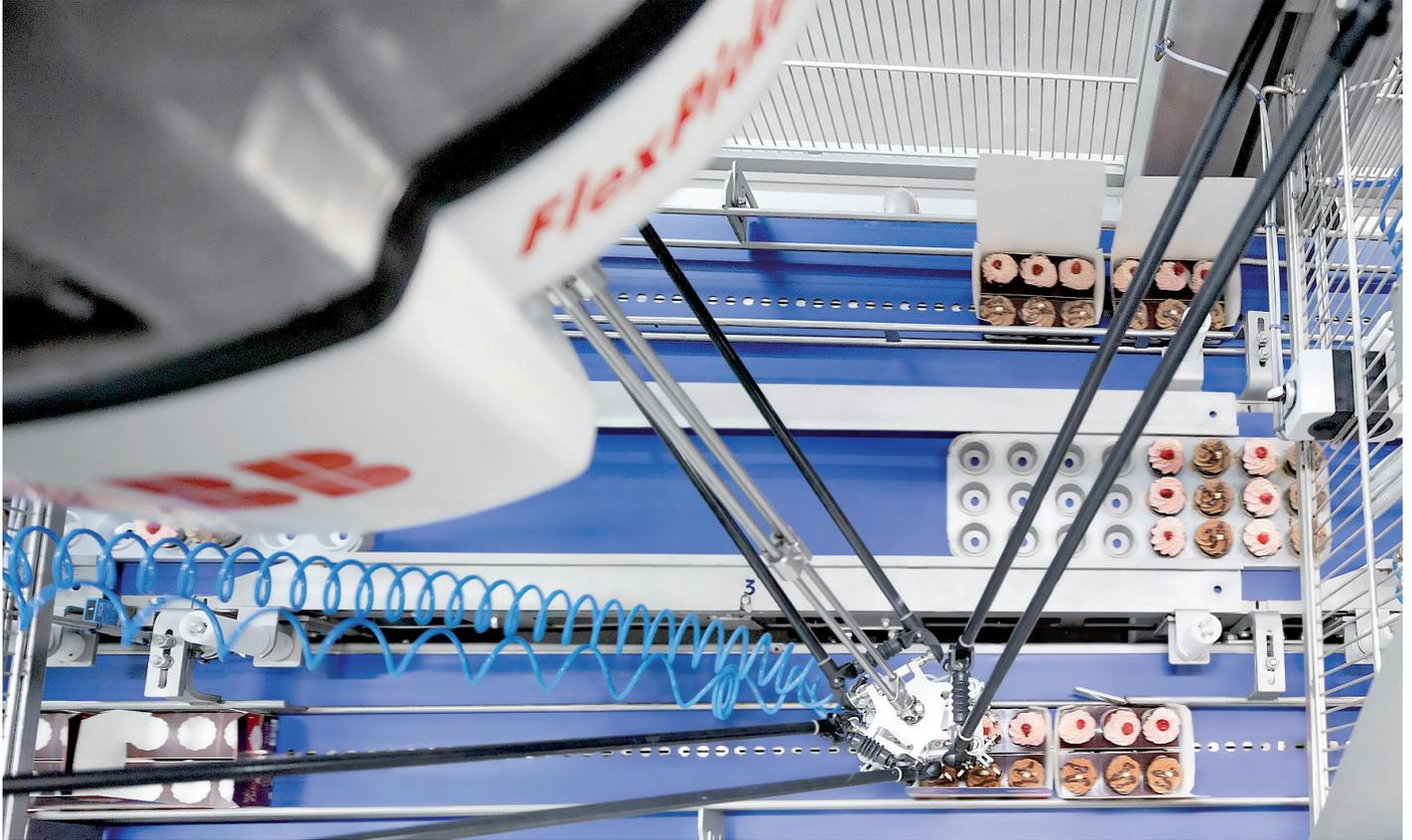
Einfach in der Programmierung, präzise in der Anwendung: Mit dem FlexPicker gelangen die kleinen Törtchen unbeschadet in die Kartons.
