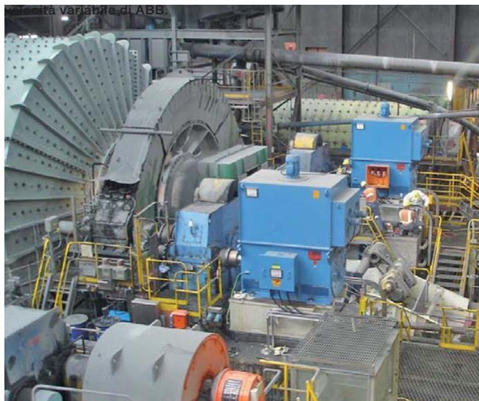
La velocità del mulino viene inoltre regolata per ottenere un risultato ottimale e il massimo rendimento, allo scopo di utilizzare in modo più efficiente la potenza di macinazione.
