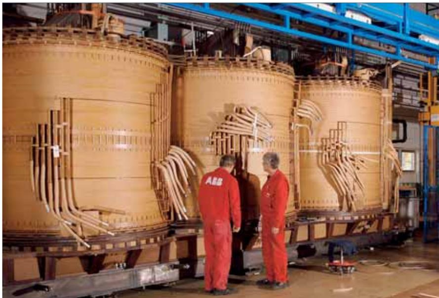
8 Reactor shunt de 150 MVAR en la red de distribución sueca de 400kV
