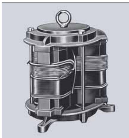
**2** El transformador elevador para generadores Harsprånget de 400 kV: unidades monofásicas con devanados de baja tensión abastecen a generadores en paralelo con una potencia nominal de 105 MVA
