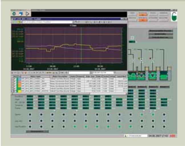
3 Remplissage du réservoir virtuel: le niveau réel (vert) suit le point de consigne optimal (jaune) et reste dans les limites de tolérance (orange).
