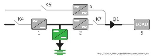
**2. Open “Q1 - UPS Output switch” (Pos. O).**
