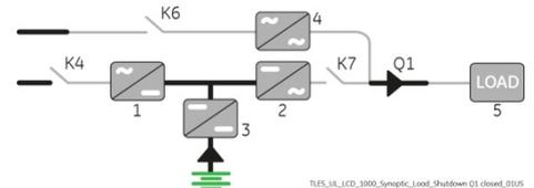
**2. Open “Q1 - UPS Output switch” (Pos. O).**
