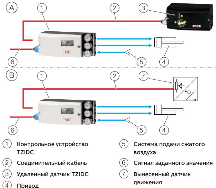
Рис. 3: TZIDC с внешними датчиками движения
