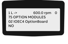
4. To enter the parameter setting function, press the ENTER key.
