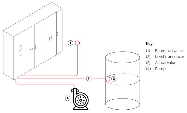
Fig. 28. PID control mode
