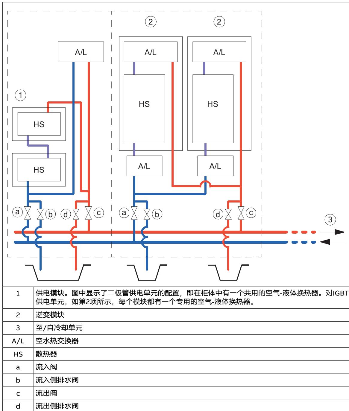
ACS880水冷传动系统使用的冷却液为25%或50%的Antifrogen® L混合液。请参见[冷却液规格 \(页 131\)](#)。
