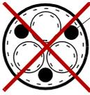
PE<br>对称屏蔽电缆，每条相导线带有单独的屏蔽层 | 否      | 否      |
