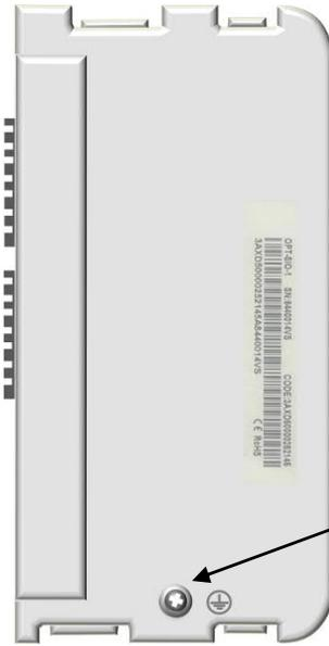
用 PZ1/PH1 螺丝刀将螺栓（附带）固定在支座上，最大力矩为 0.3N\*m。
