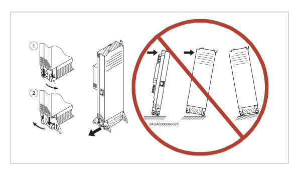
Para evitar que o módulo de acionamento caia, fixe os olhais de elevação superiores com correntes ao armário (1) antes de empurrar o módulo para o interior do armário ou de o puxar para fora do armário. Empurre o módulo para o interior do armário e puxe-o para fora do armário com cuidado, de preferência com a ajuda de outra pessoa. Mantenha uma pressão constante com um pé na base do módulo (2) para evitar que o módulo caia para trás.
