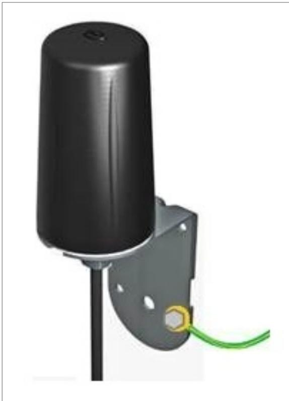
5. Den Montagewinkel für die Antenne über einen 6-mm<sup>2</sup>-Erdungsleiter erden.
