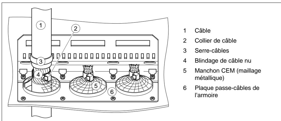
2. Torsadez le blindage des câbles moteur en faisceaux que vous raccorderez, ainsi que n'importe quel conducteur ou câble de terre, à la borne de terre du module variateur.
