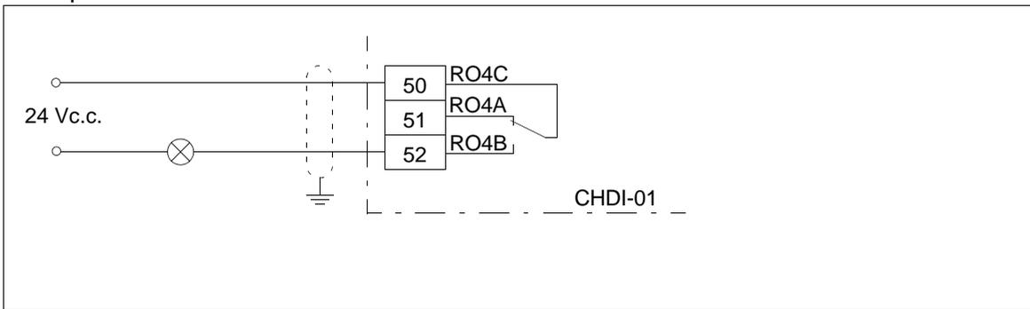
Exemple de raccordement d'une entrée logique
