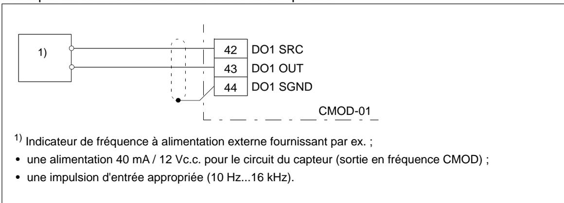
Exemple de raccordement d'une alimentation externe
