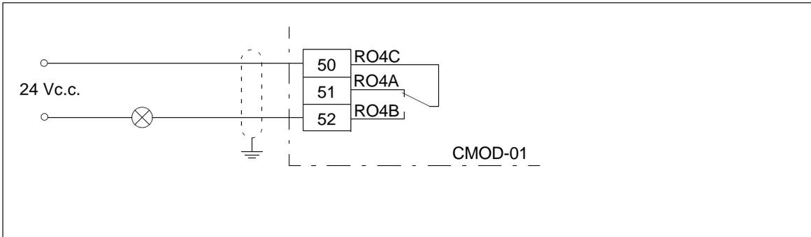
Exemple de raccordement d'une sortie logique
