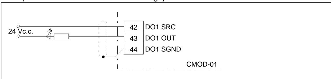
Exemple de raccordement d'une sortie en fréquence
