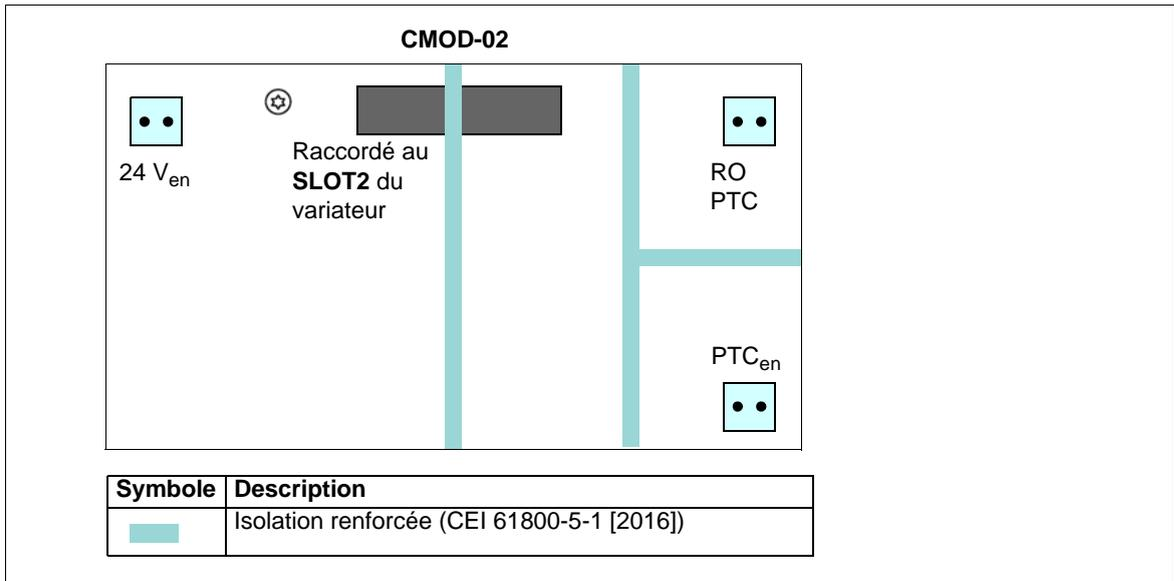
**Raccordement thermistance moteur (60...61) :**
