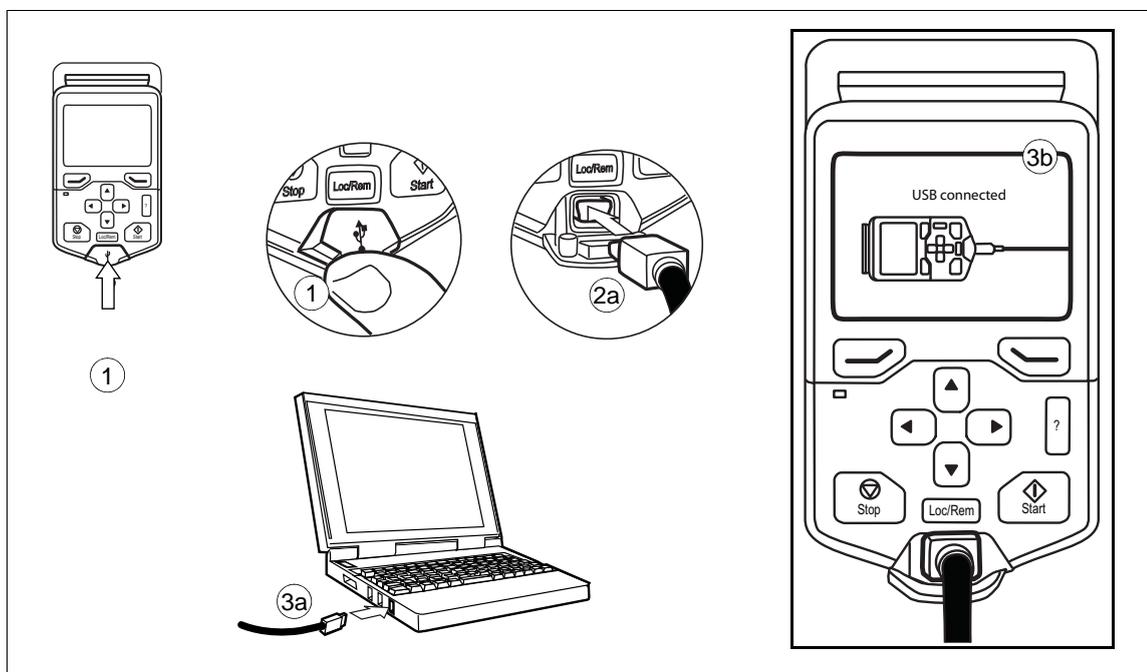
**N.B. :** Lorsqu'un PC est raccordé à la microconsole, les touches de la microconsole sont désactivées. Dans ce cas, la microconsole fait office d'adaptateur UBS-RJ45.
