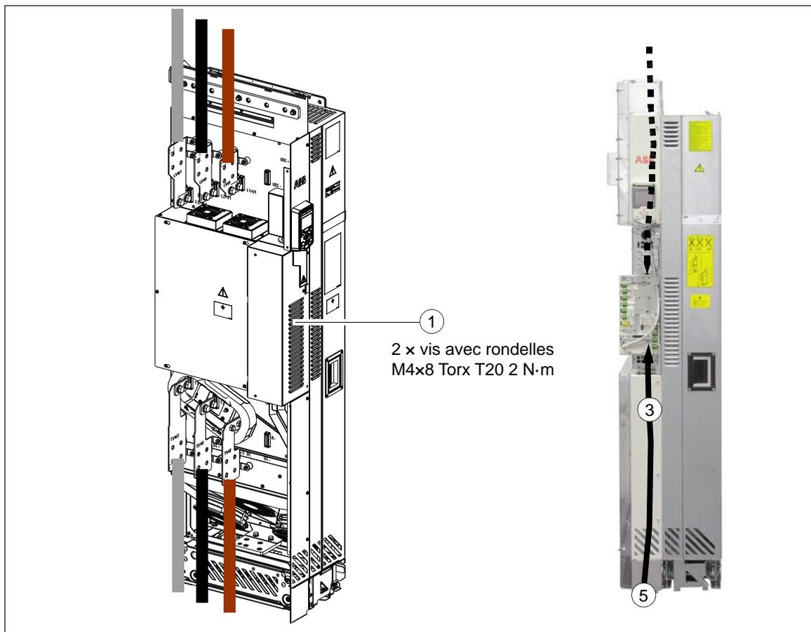
2. Attachez les modules optionnels s'ils ne le sont pas encore. Cf. section [Installation des modules optionnels](#) page 89.
