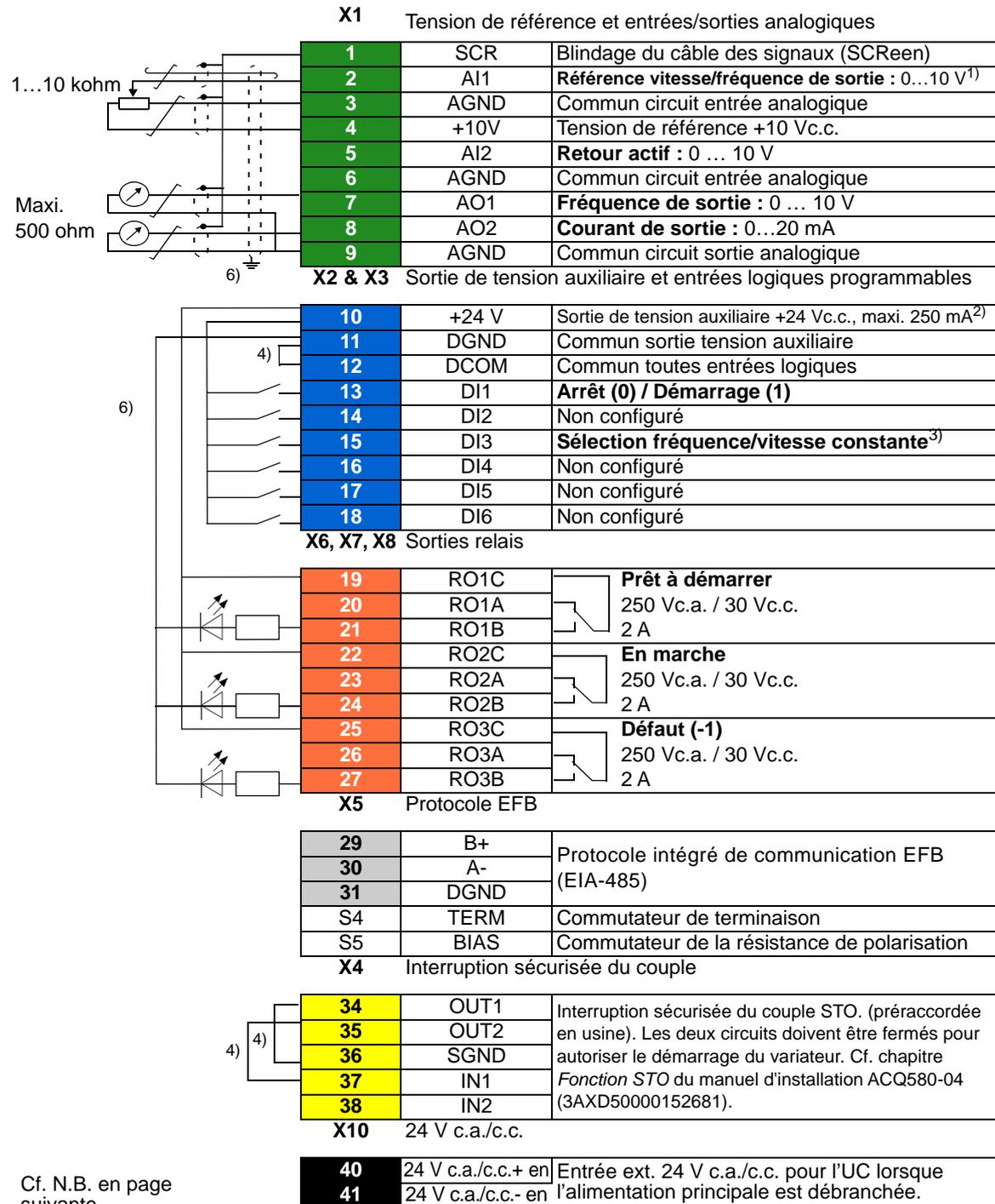
La capacité de charge totale de la sortie en tension auxiliaire +24V (X2:10) est 6,0 W (250 mA / 24 V c.c.).
