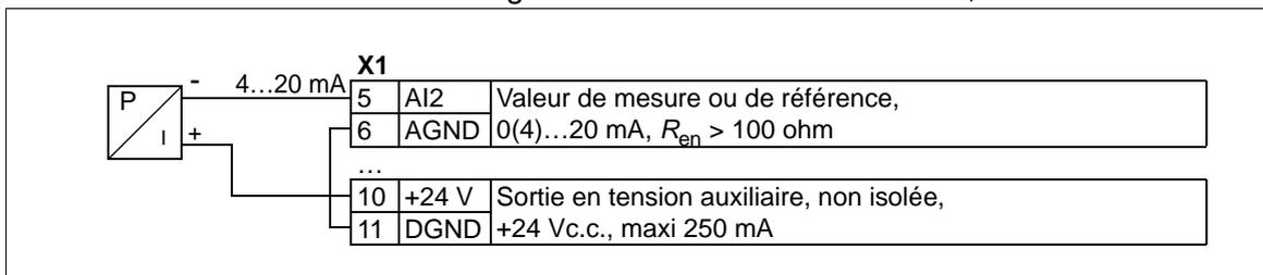
Le schéma ci-dessous illustre un exemple de capteur trois fils alimenté par la sortie en tension auxiliaire du variateur. Le capteur est alimenté par sa sortie en courant et le variateur fournit la tension d'alimentation (+24 Vc.c.). Par conséquent, le signal de sortie doit être 4...20 mA, non 0...20 mA.
