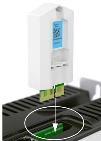
振动环境中，建议将存储单元用螺钉固定在驱动器上。螺钉在随附的安装包中。
