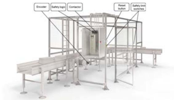
Figure 7. Les moniteurs de sécurité reçoivent et envoient des impulsions de sécurité au variateur. D'autres dispositifs de sécurité et câblages sont nécessaires par rapport à la sécurité fonctionnelle intégrée basée sur les variateurs (voir la fig. 8)
