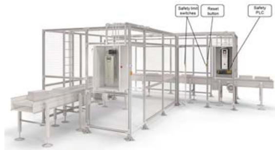
Figure 9. Un système de sécurité avec des fonctions de sécurité traditionnelles et intégrées basées sur les variateurs, contrôlées par un PLC de sécurité.
