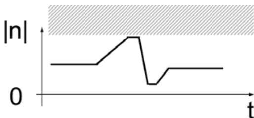
Figure 4. Lorsque la fonction SMS est utilisée, elle est toujours active et s'assure que la vitesse limite définie n'est pas dépassée (c'est-à-dire la vitesse maximale autorisée).
