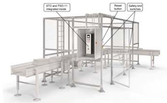
Figure 8. La logique de sécurité intégrée au variateur pour une surveillance efficace de la sécurité. Moins de dispositifs de sécurité et de câblage sont nécessaires par rapport à une solution de sécurité fonctionnelle traditionnelle basée sur les variateurs (voir fig. 7).
