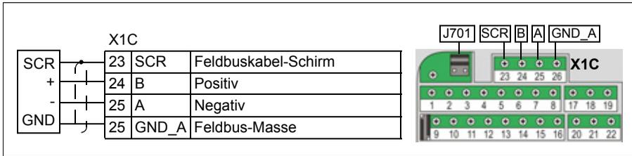
Den EIA-485-Bus mit einem 120 Ohm-Widerstand auf der Seite des Netzwerks abschließen; hierzu die Jumper J701, wie in der folgenden Abbildung dargestellt, stecken.
