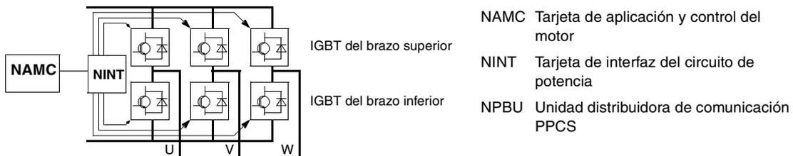
**Diagrama de bloques de la unidad inversora (de dos a cuatro inversores paralelos)**
