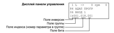
**Пример.** На аналоговый вход ABX 1 подано напряжение 5,8 В, привод работает под управлением стандартной прикладной программы ACS800. Как подключить сигнал к блоку MAX в адаптивной программе? Каково значение на входе блока?
