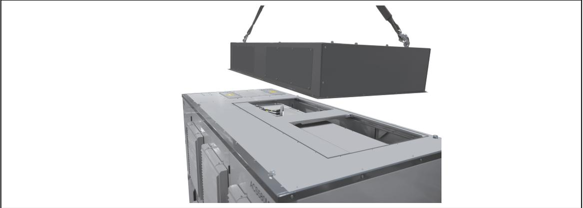
2. Lift fan unit onto the air channel.
