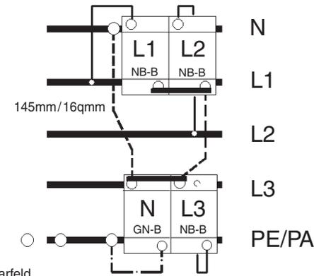
Isolierteile für CU-Schiene nach Phasenangabe
