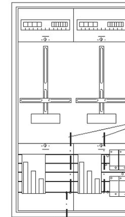
Zusätzliche PE-Leitung zu PE-Schiene im Unterverteiler Querschnitt nach DIN VDE. Siehe auch VDEW-Richtlinie "Überspannungsschutzeinrichtungen der Anforderungsklasse B".
