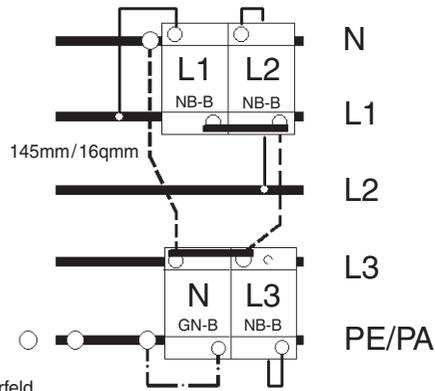
Isolierteile für CU-Schiene nach Phasenangabe
