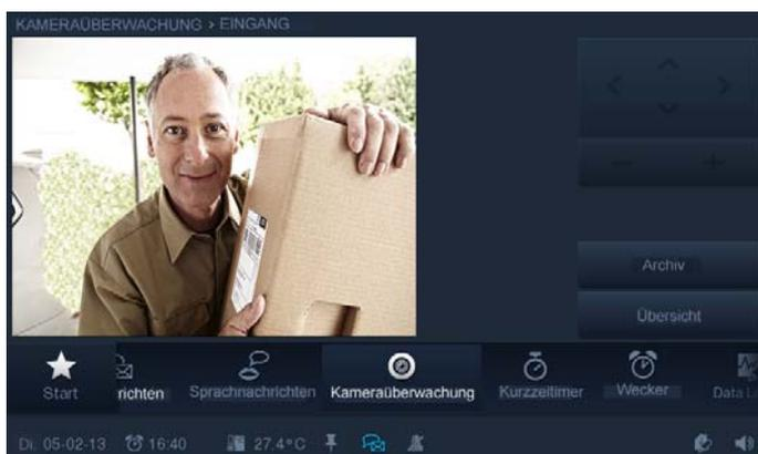
Als Voraussetzung müssen die Überwachungskameras IP-fähig sein. Die Archivfunktion muss über IP-Project 3 aktiviert sein.
