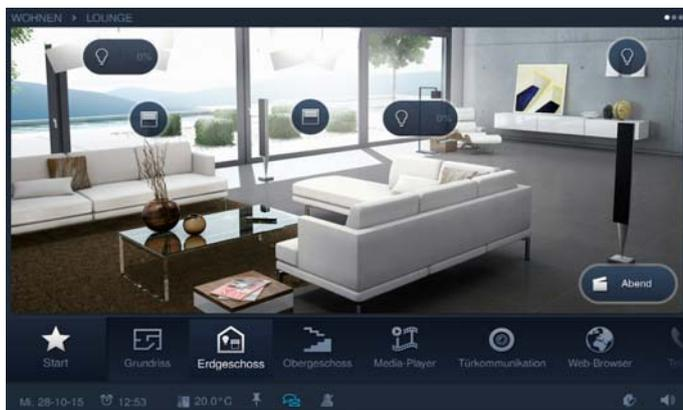
Weiterhin ist es möglich, diese Verbraucher über hinterlegte Bedienelemente direkt zu bedienen. Die Positionierung des Bedienelementes im Hintergrund kann im Raster 3 x 4 erfolgen. Um verschiedene Ansichten eines Raumes möglich zu machen, können bis zu fünf weitere Bedienseiten mit Raumbild hinterlegt werden, die dann über das Auswahlménü am rechten Bildschirmrand aufrufbar sind.
