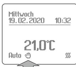
Abb. 15: Betriebsmodus: AUTO mit manuell eingestelltem Sollwert
