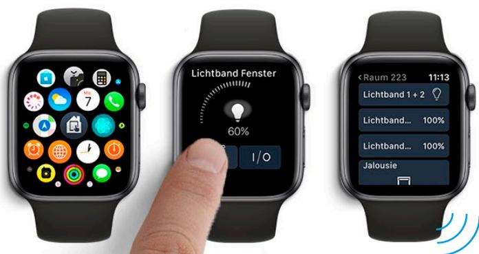
Smartphones, Tablets, Smartwatches oder der Windows PC werden zur praktischen Fernbedienung dank Busch-ControlTouch®. Es verbindet die KNX-Installation mit dem IP-Netzwerk und ermöglicht die Steuerung aller KNX-Funktionen im Gebäude. Applikationen für iOS und Android sorgen für eine intuitive Bedienung. So können Schalter, Dimmer, Jalousien, Szenen, IP-Kameras, UPnP-Geräte (zum Beispiel Sonos-Wireless-Boxen), Philips-Hue-Leuchten und vieles mehr in das System eingebunden werden.
