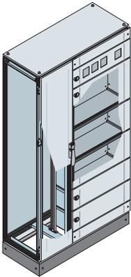
Vormontierte Baueinheit Serie IS2 Abmessungen: 1800 x 1000 x 400 (1805 x 994 x 410) mm. (H x B x T außen) IP65 Version mit geschotteten Zellen Form 3, Kabelhochführung B = 400 mm mit Modulplatte für Messgeräte und Stahlblechtüren für PC-MCC, Sockel H = 100 mm (Sockelblenden inbegriffen).
