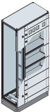
Vormontierte Baueinheit Serie IS2 Abmessungen: 1800 x 800 x 400 (1805 x 794 x 410) mm. (H x B x T außen) IP65 Version mit geschotteten Zellen Form 3, Kabelhochführung B = 200 mm mit Modulplatte für Messgeräte und Stahlblechtüren für PC-MCC, Sockel H = 100 mm (Sockelblenden inbegriffen).
