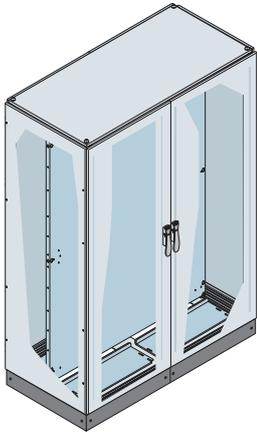
Vormontierte Baueinheit Serie IS2 Abmessungen: 2000 x 1200 x 600 (2105 x 1210 x 610) mm (H x B x T außen) IP65 mit Stahlblechtür, Montageplatte, Seitenwänden, Kabeleinführungsplatten und Sockel H = 100 mm (Sockelblenden inbegriffen).
