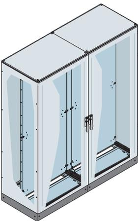
2 vormontierte Baueinheiten Serie IS2 Abmessungen: 2000 x 800 x 600 (2105 x 1604 x 610) mm (H x B x T außen) IP65 mit Stahlblechtür, Montageplatte, Seitenwänden, Kabeleinführungsplatten gleitend, Verbindungsbausatz Baueinheiten/Platten und Sockel H = 100 mm (Sockelblenden inbegriffen).
