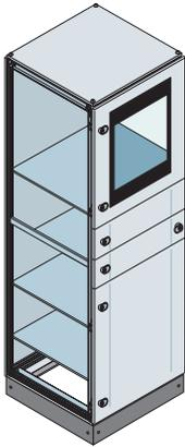
Vormontierte Baueinheit Serie IS2 Abmessungen: 2000 x 600 x 600 (2105 x 610 x 610) mm (H x B x T außen) IP65 Version für PC mit Glastür für Monitor, Tastaturträger, Modul für CPU, Seitenwänden und Sockel H = 100 mm (Sockelblenden inbegriffen).
