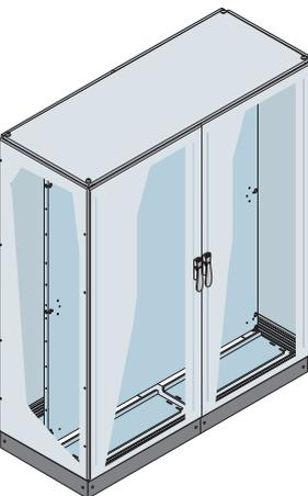
Vormontierte Baueinheit Serie IS2 Abmessungen: 2000 x 1600 x 600 (2105 x 1610 x 610) mm (H x B x T außen) IP65 mit Stahlblechtür, Montageplatte, Seitenwänden, Kabeleinführungsplatten und Sockel H = 100 mm (Sockelblenden inbegriffen).
