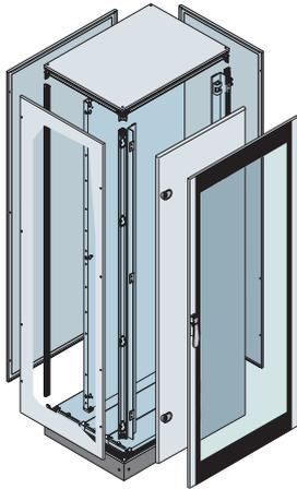
In Einzelteilen gelieferte Baueinheit Serie IS2 Abmessungen: 2200 x 800 x 600 (2305 x 810 x 610) mm. (H x B x T außen) IP65 mit Glastür, Innentür, Montageplatte, Seitenwände, Kabeleinführungsplatte modular und Sockel H = 100 mm (Sockelblenden inbegriffen).
