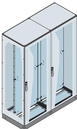
2 vormontierte Baueinheiten Serie IS2 Abmessungen: 2000 x 600 x 600 2105 x 1204 x 610 mm (H x B x T außen) IP65 mit Stahlblechtür, Montageplatte, Seitenwänden, Kabeleinführungsplatten gleitend, Verbindungsbausatz Baueinheiten/Platten und Sockel H = 100 mm (Sockelblenden inbegriffen).
