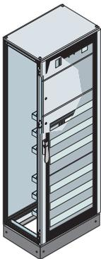
Vormontierte Baueinheit Serie IS2 Abmessungen: 1800 x 600 x 400 (1805 x 594 x 410) mm. (H x B x T außen) IP65 modulare Version mit Abdeckung für Geräte und Glastür, DIN-Platten, Sockel H = 100 mm (Sockelblenden inbegriffen).
