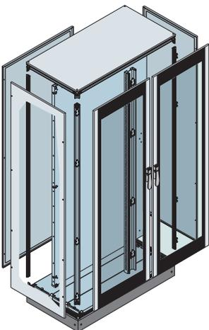
In Einzelteilen gelieferte Baueinheit Serie IS2 Abmessungen: 2000 x 600 x 600 mm (2105 x 1010 x 610 mm extern H x B x T außen) IP65 mit Doppeltür mit Falzverschluss, Montageplatte, Seitenwände, Kabeleinführungsplatte modular und Sockel H = 100 mm (Sockelblenden inbegriffen).
