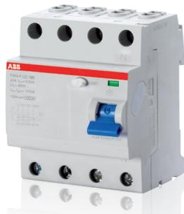
**F204 Typ F, FI (RCCB)** in vierpoliger Ausführung mit einem Bemessungsstrom von 25, 40, 63 A und einem Bemessungsfehlerstrom von 30 mA zum Schutz von mehreren einphasigen Stromkreisen mit einem einzigen Gerät.
