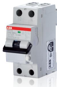
**DS201 Typ F, kompakter FI/LS-Schalter (RCBO) (1P+N)** mit einem Bemessungsstrom von 6...40 A, B- und C-Charakteristik und einem Bemessungsschaltvermögen von 10 kA in nur zwei Modulen.
