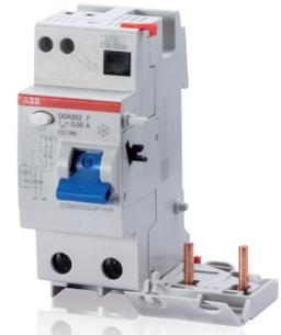
**DDA 202 Typ F, FI-Blöcke (RCU)** (zum Anbau an Sicherungsautomaten S202) in zweipoliger Ausführung mit einem Bemessungsstrom von 40 und 63 A sowie einem Bemessungsfehlerstrom von 30 mA – für schnelle und flexible Lösungen.
