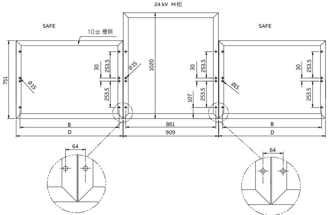
SafePlus与24 kV M柜连接时基础槽钢俯视图
