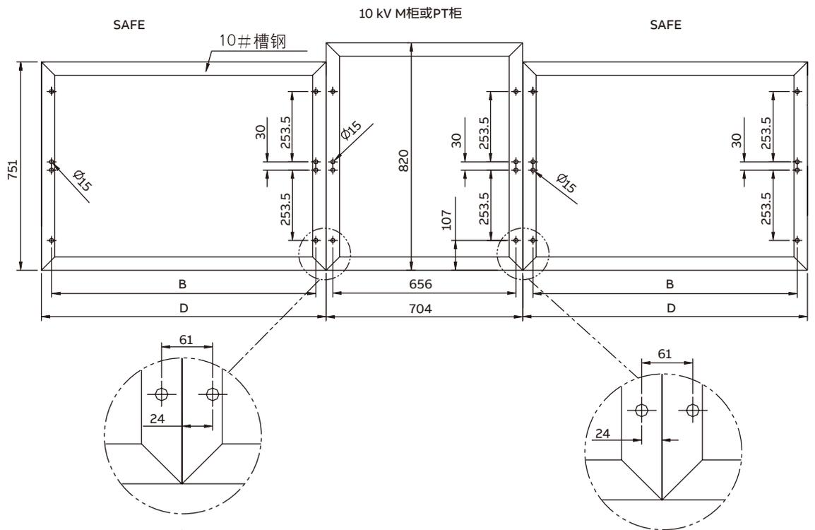
SafePlus与10 kV M柜或PT柜连接时基础槽钢俯视图
