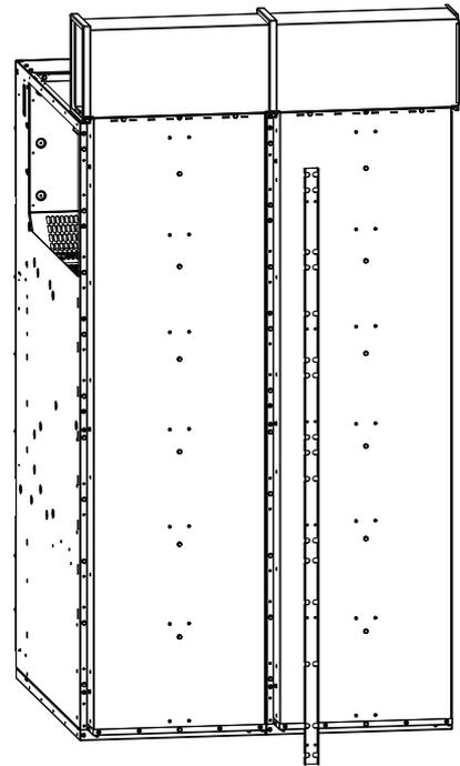
Figura 49. Posizioni delle viti per unità WBC - WBS
