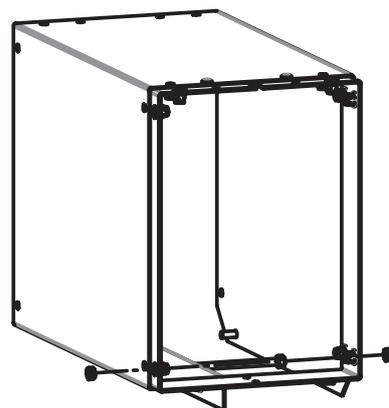
Figura 76. Viti e dadi per il condotto orizzontale
