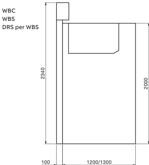
Figura 7. Vista laterale per pannelli con interruttore estraibile, IAC A-FLR 25 kA, 1s fino a 17,5 kV e IAC A-FLR 21kA, 1s a 24 kV con condotto
