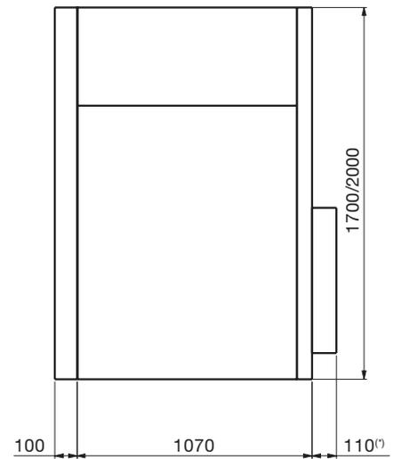
Figura 4. Vista laterale IAC A-FLR 16 kA, con filtri
