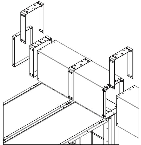
Figura 79. Condotto di sfogo dei gas collegato; condotto supplementare e piastra terminale
