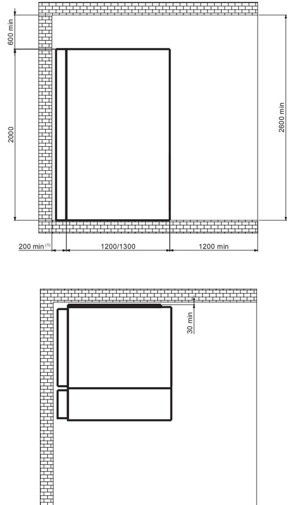
Figura 31. Distanze minime rispetto alle pareti del locale di installazione, soluzione IAC A-FLR 21/25(2) kA 1s con scarico dei gas verso il basso
