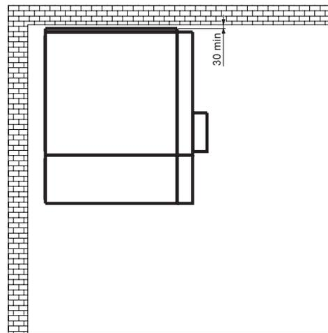
Figura 25. Distanze rispetto alle pareti del locale di installazione con vano sfogo dei gas sul retro, soluzione IAC A-FL 12,5 kA 1s addossata a parete
