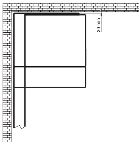
Figura 33. Distanze minime rispetto alle pareti del locale, soluzione IAC A-FLR 25 kA, 1s @ 12-17,5 e 21 kA, 1s @ 24 kV con condottilo sfogo gas
