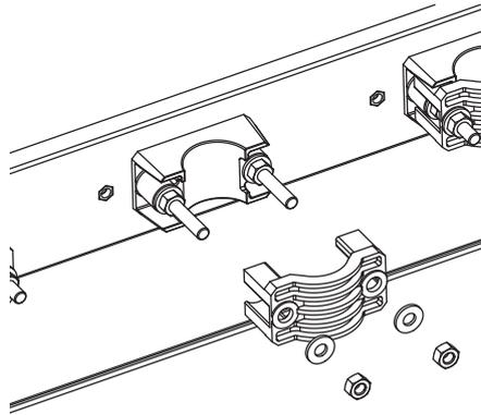
Figura 106. Disegno esploso degli elementi di bloccaggio dei cavi sul fondo dell'unità RLC
