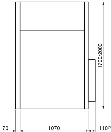
Figura 3. Vista laterale IAC A-FL 12,5 kA, con i filtri
