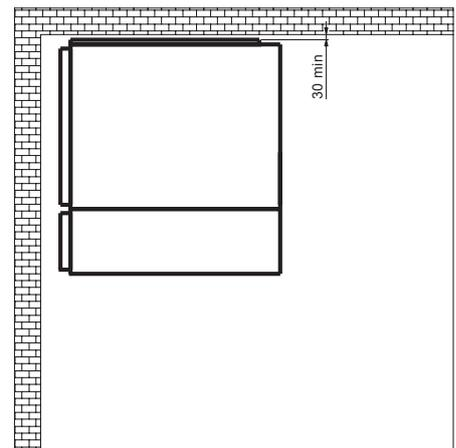
Figura 34. Distanze minime rispetto alle pareti del locale di installazione, soluzione IAC A-FL 12,5 kA 1s con filtri montati su ogni singola unità
