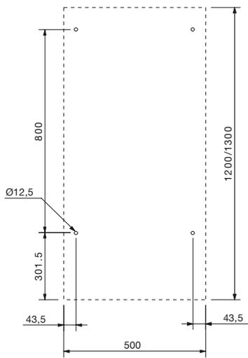
Larghezza 600 mm per le unità con interruttore automatico estraibile fino a 17,5 kV WBS e BME senza uscita cavi
