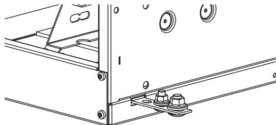
Figura 120. Conduttore di sbarra protettivo dell'unità SBR
