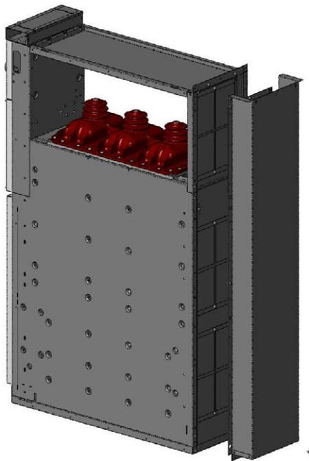
Figura 73. Installazione del condotto di sfogo dei gas verticale
