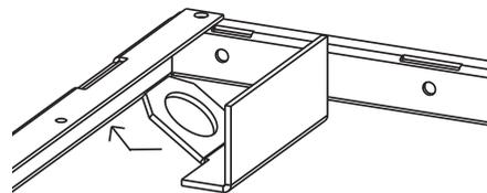
Figura 19. Telaio del tetto + ganci di sollevamento
