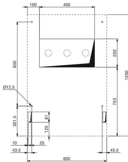
Larghezza 750 mm per le unità con interruttore automatico estraibile fino a 24 kV WBS senza uscita cavi
