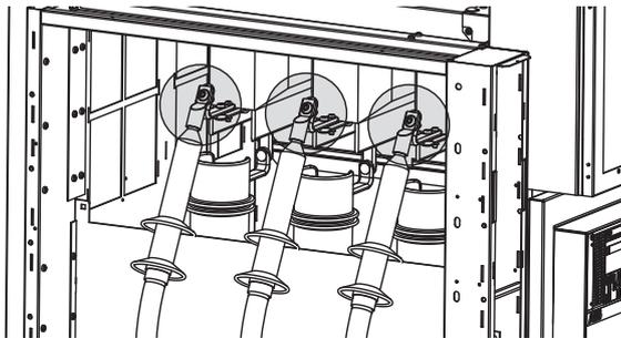
Figura 107. Collegamenti dei terminali dei cavi dell'unità RLC
