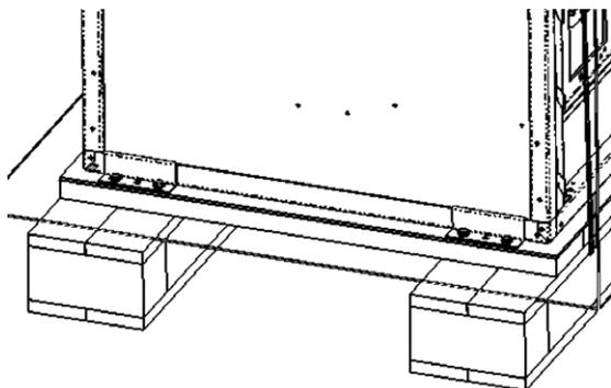
Figura 12. Placche di montaggio all'esterno dell'unità 750 mm
