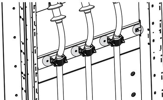
Figura 108. Terminali dei cavi di messa a terra dell'unità RLC
