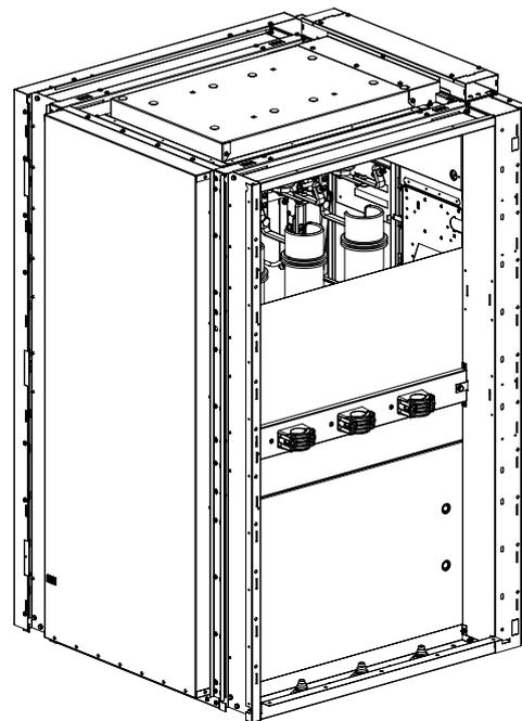
Figura 104. Elementi di bloccaggio dei cavi dell'unità RLC
