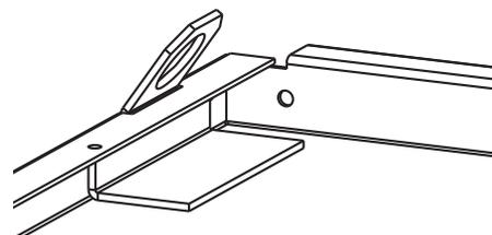
Figura 20. Gancio di sollevamento installato sul telaio del tetto
