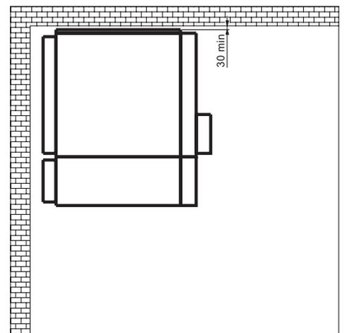
Figura 27. Distanze minime rispetto alle pareti del locale di installazione, soluzione IAC A-FL 12,5 kA 1s con filtri montati su ogni singola unità
