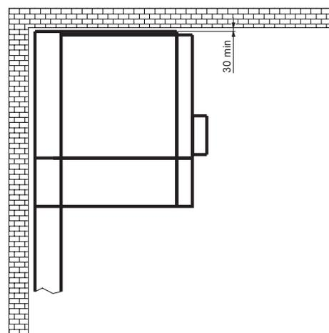
Figura 29. Distanze minime rispetto alle pareti del locale di installazione, soluzione IAC A-FLR 21 kA 1s con filtri montati su ogni singola unità
