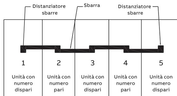
Figura 50. Connessioni delle sbarre principali
