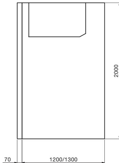
Figura 8. Vista laterale per pannelli con interruttore estraibile IAC A-FL 12,5 kA 1s con filtri
