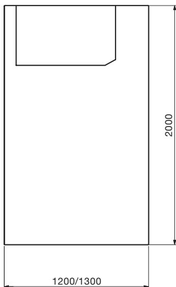
Figura 9. Vista laterale per pannelli con interruttore estraibile IAC A-FL 12,5 kA 1s (soluzione completamente addossata a parete)
