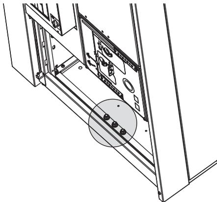
Figura 119. Sbarra di terra protettiva principale dell'unità SBR
