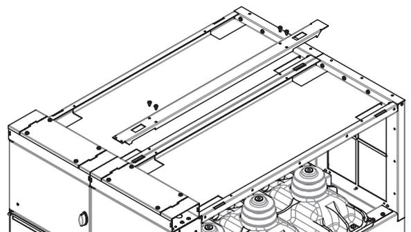
Figura 72. Profilo di giunzione del tetto
