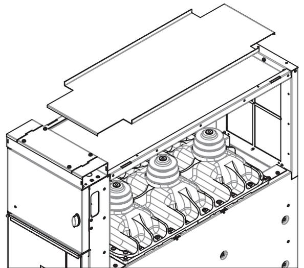
Figura 71. Installazione della doppia piastra del tetto
