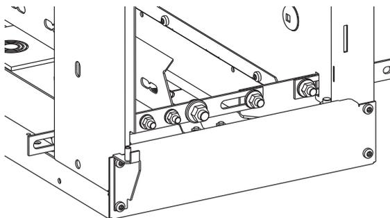
Figura 117. Sbarra di terra installata
