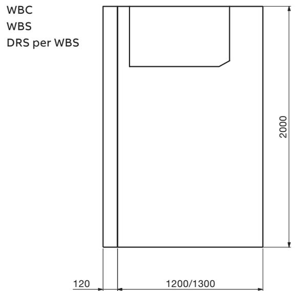
Figura 6. Vista laterale per pannelli con interruttore estraibile, IAC A-FLR 25 kA, 1s fino a 17,5 kV e IAC A-FLR 16 kA, 1s a 24 kV con filtri
