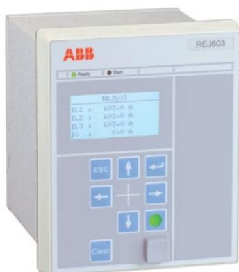
REJ603 è una relè di protezione di linea digitale. Viene utilizzato per la protezione selettiva da corto circuito e da guasto di terra delle reti di distribuzione. Inoltre, protegge i piccoli trasformatori nelle utility e nelle industrie.
