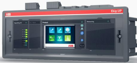
Ekip UP modernise et rénove les systèmes électriques basse tension en exploitation de 100 à 6300 A et de 220 à 1150 V AC. Il s'installe sur rail Din dans le tableau électrique basse tension ou en face avant de ce dernier et s'interface aux appareillages BT « toutes marques » déjà installés évitant ainsi leur coûteux et complet remplacement.
