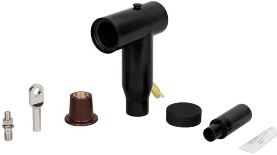
ABB全屏蔽可分离式连接器是用于将交联聚乙烯绝缘电力电缆连接到变压器，开关柜，电缆分支箱等带设备套管的电气设备的预制式连接组件。该组件可以提供全屏蔽的、安全可靠的插拔式连接，可与标准的设备套管配合。
