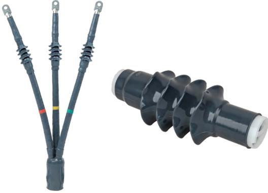
ABB冷缩型电缆终端是一种安装及其简便的中压电缆连接产品，可广泛的用于户内及户外电力系统内。采用高介电常数应力控制，和终端本体一体化的设计，有效的降低了电缆表面的电应力，且绝缘性能出众。
