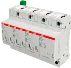
总配电进线处的第 I 级防雷保护。OVR T1-T2 系列为 I + II 级复合型电涌保护器，承受 10/350 $\mu$ s 波形直击雷冲击电流。
