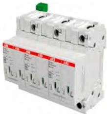
总配电进线处的第 I 级防雷保护。OVR T1-T2 系列为 I + II 级复合型电涌保护器，承受 10/350 $\mu$ s 波形直击雷冲击电流。
