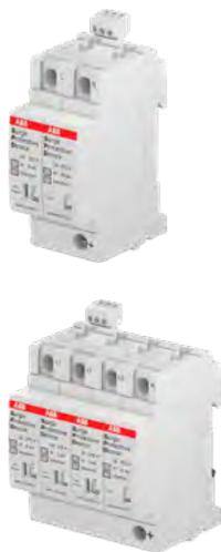
配电终端设备第III级(或第II级)组合式防雷, II类试验(8/20 $\mu$ s)和III类试验, 承受8/20 $\mu$ s冲击电流和1.2/50 $\mu$ s冲击电压的组合波形, 应尽可能安装于敏感设备前端, 达到精细保护的目。
