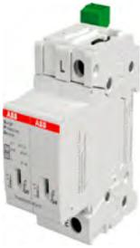
总配电进线处的第 I 级防雷保护。OVR T1-T2 系列为 I + II 级复合型电涌保护器，承受 10/350 $\mu$ s 波形直击雷冲击电流。单极产品可任意组成 2P/1P+N/3P/3P+N/4P 接线形式。
