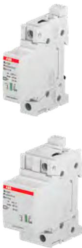
分配电进/出线处的第 II 级防雷，泄放 8/20 $\mu$ s 波形的雷电流，保护电气装置和电子设备。分配电进/出线处的第 II 级防雷，泄放 8/20 $\mu$ s 波形的雷电流，保护电气装置和敏感设备免受间接雷击的影响。单极产品可任意组成 2P/1P+N/3P/3P+N/4P 接线形式。
