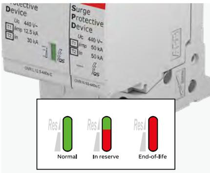
安全储备系统是一种扩展性的保护，如OVR T1-T2 s和T2s。每极配备两个压敏电阻。如果一个压敏电阻损坏，电涌保护器将提前发出警告，表示其寿命即将终结，而另一个压敏电阻将继续保护设备，以便进行预防性维护。
