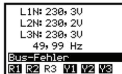
Das Gerät hat innerhalb der eingestellten Zeitüberschreitung kein gültiges Modbus-Telegramm erhalten.
