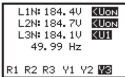
Die Spannung an L3 hat den ersten Unterspannungsschwellwert unterschritten. Die Spannungen an L1 und L2 haben die Zuschaltbedingungen, jedoch nicht den Unterspannungsschwellwert unterschritten
