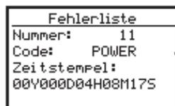
Die Unterbrechung der Versorgungsspannung wird mit dem dazugehörigen Zeitstempel in der Fehlerliste gespeichert.
