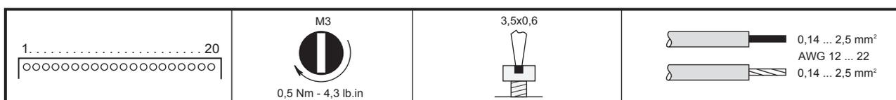
Рисунок 25: Усилия затяжки и размеры кабелей (1 мм = 0,0394 дюйма)
