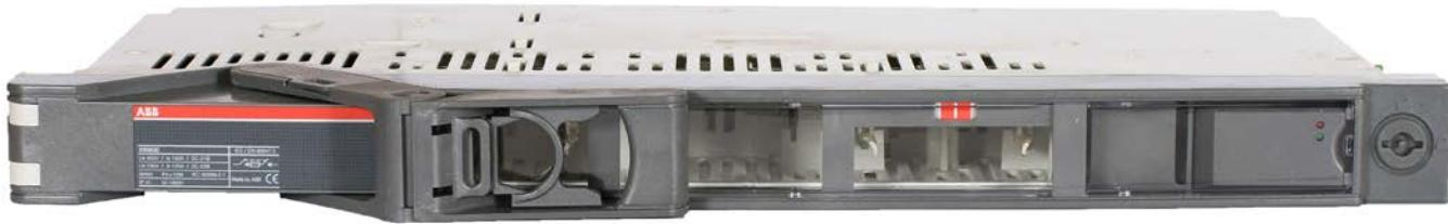
SlimLine XR EFM gir en alarm ved eventuelle feiltilstander hvis en sikring ryker. Et internt potensialfritt relé (1 NC + 1 NO) vil gi signal ved sikringsbrudd. EFM enheten er selvforsynt, noe som betyr at ingen ekstra strømforsyning er nødvendig.
