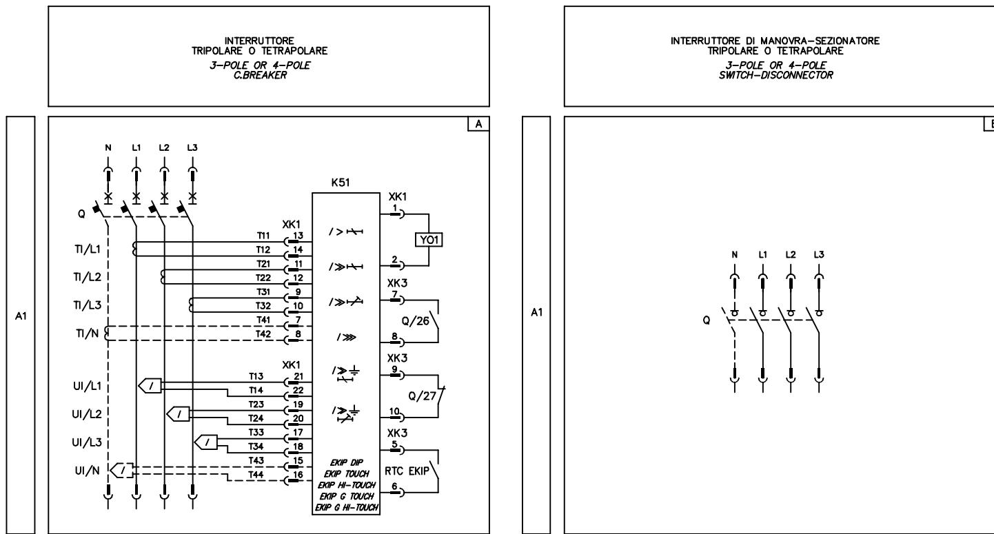
SCHEMA CIRUITALE PER L'ADATTAMENTO DR DI INTERRUTTORI EMAX2 E2.2-E4.2 IN SOSTITUZIONE DI INTERRUTTORI
