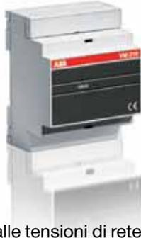
I segnali, associati alle tensioni di rete, in uscita dai morsetti 3, 4, 5 e 6, del VM210, sono portati in ingresso allo sganciatore attraverso i morsetti 5, 6, 7 e 8 dell'apposito connettore X4 secondo lo schema di Figura D.4.
