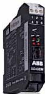
SD-GEM è un gateway<sup>10</sup>, che realizza la conversione dal protocollo Modbus/TCP al protocollo Modbus RTU, e permette quindi d'integrare gli interruttori automatici di bassa tensione ABB (con interfaccia di comunicazione Modbus RTU) nei sistemi di Supervisione su reti Ethernet TCP/IP (con protocollo Modbus TCP).
