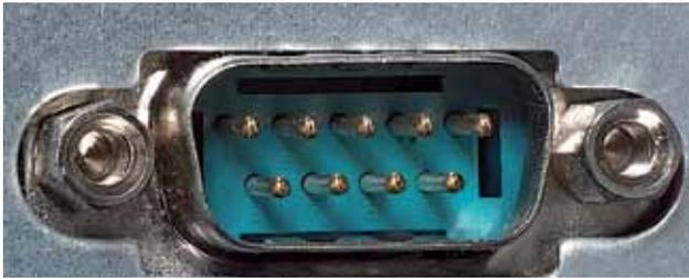
Figura 10: Cavo seriale RS-232 a 9 pin
