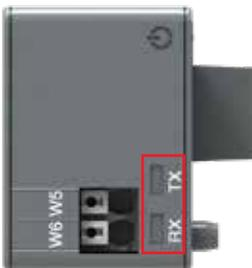
Fig. 5.15 Signals of Ekip Com Profibus DP -module
