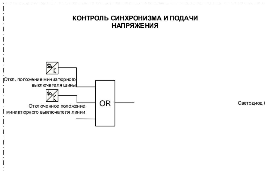
Рис. 33: Функция контроля синхронизма и подачи напряжения
