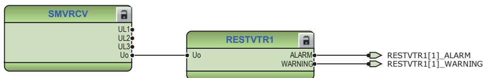
Рис. 53: Подключение SMVRCV к RESTVTR1 в Инструменте конфигурации приложений
