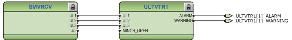
Рис. 89: Подключение SMVRCV к ULTVTR1 в Инструменте конфигурации приложений
