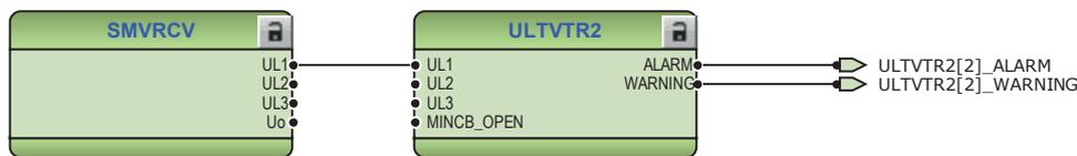
Рис. 57: Подключение SMVRCV к ULTVTR2 в Инструменте конфигурации приложений
