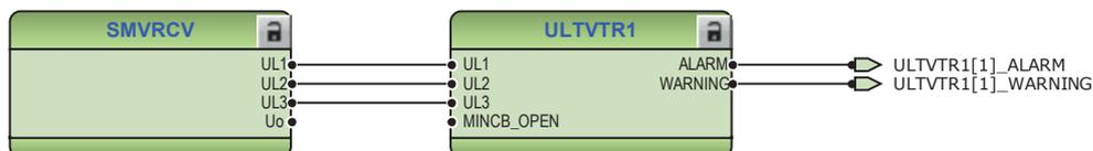
Рис. 51: Подключение SMVRCV к ULTVTR1 в Инструменте конфигурации приложений
