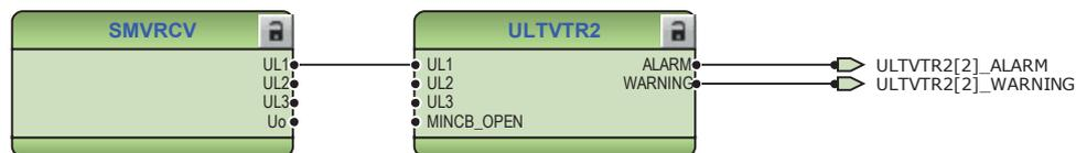
Рис. 91: Подключение SMVRCV к ULTVTR2 в Инструменте конфигурации приложений
