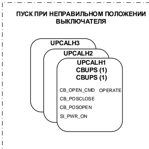
*Рис. 45:*      *Функция пуска при неправильном положении выключателя*
