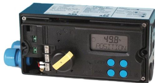
Рис. 6: Открытый TZIDC-110 с видом на панель управления
