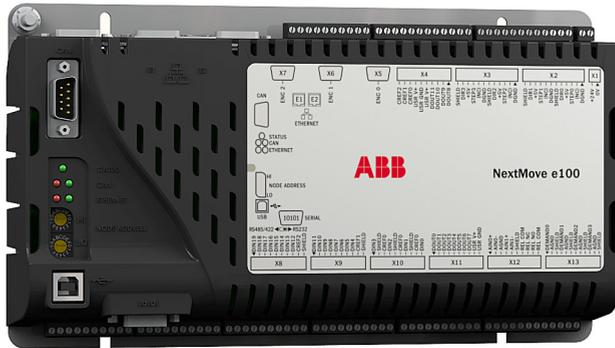
El NextMove e100 incluye el idioma de control de movimientos Mint. Mint es una forma estructurada de Basic, diseñada específicamente para aplicaciones de control de movimientos servoasistidos o de motores de velocidad gradual. Le permite empezar muy rápidamente con programas de control de movimiento simples. Además, Mint incluye un amplio rango de comandos potentes para aplicaciones complejas.
